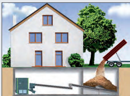
Przykład: Transport paliwa do oddalonego magazynu za pomocą podwójnego podajnika
