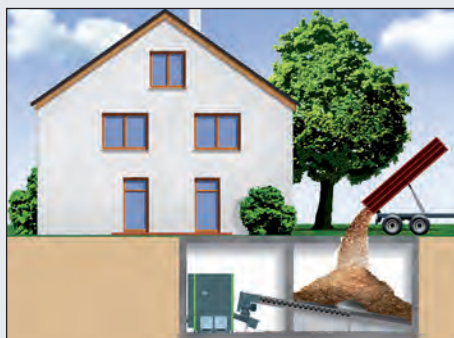
Przykład: Magazyn w przyziemiu z najazdowym dekiem zamykającym
