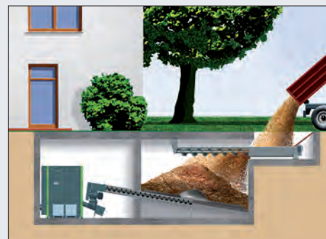
Przykład: Magazyn w piwnicy z podajnikiem napełniającym i komorą zasypową
