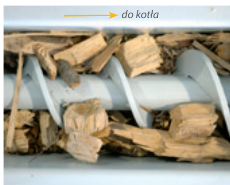
Zwiększający się skok zwoju ślimaka zapewnia równomierne i niezawodne przenoszenie materiału opałowego.
