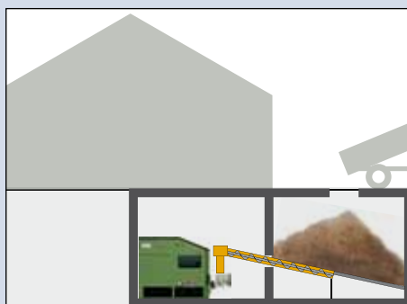
Przykład: Pomieszczenie magazynowe wpuszczone w grunt ze stropem, na który może wjechać samochód
