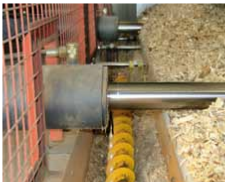
Ruchome elementy podłogi (zgrzeblą) napędzane są siłownikami hydraulicznymi.
