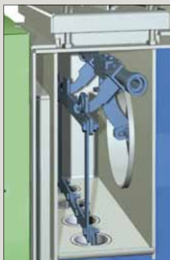
Przepustnica spalin zamknięta.
